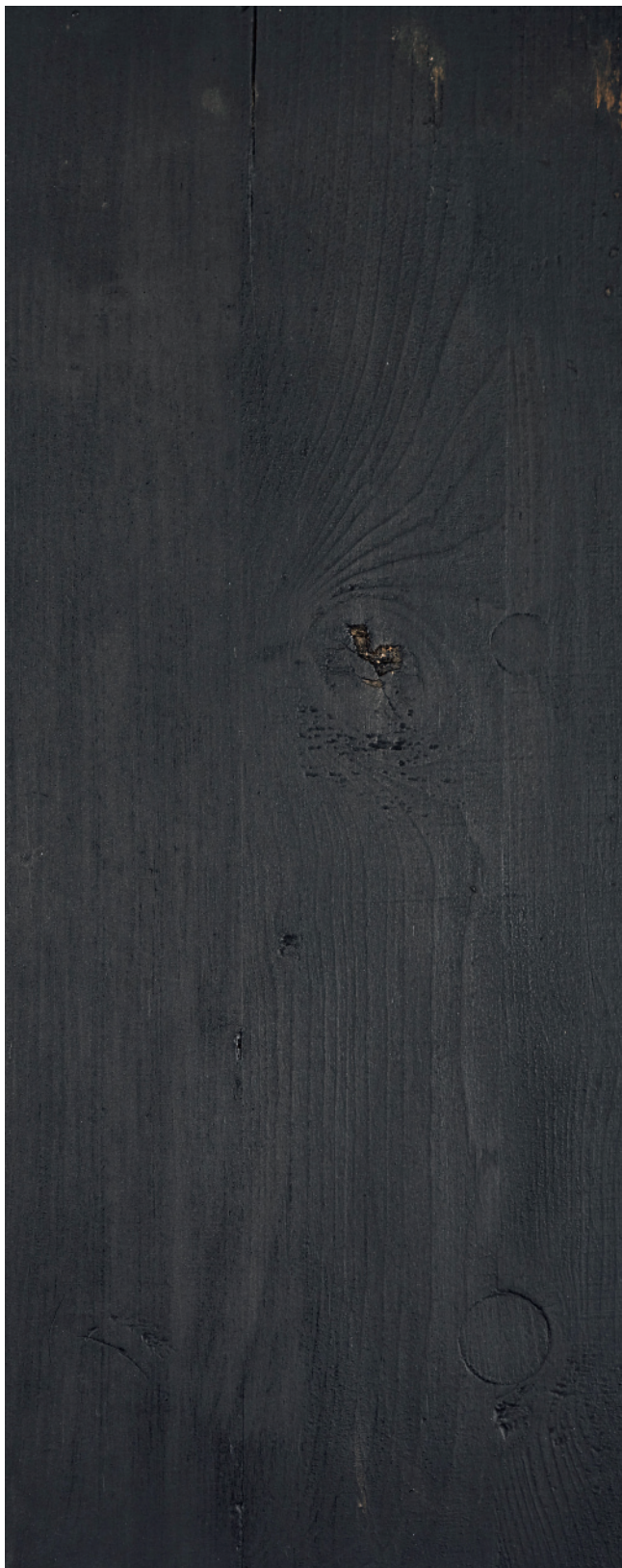
Abb.5 Nachgestellter Anstrich, aus Russ und Leimtempera hergestellt und nach dem Trocknen mit dem Lappen poliert. Als Russpigment wurde moderner Flammruss verwendet, da Kienruss nicht mehr erhältlich ist (Proben zu dessen Generierung: Dipl.-Restauratorin Sabine Grimmig).
