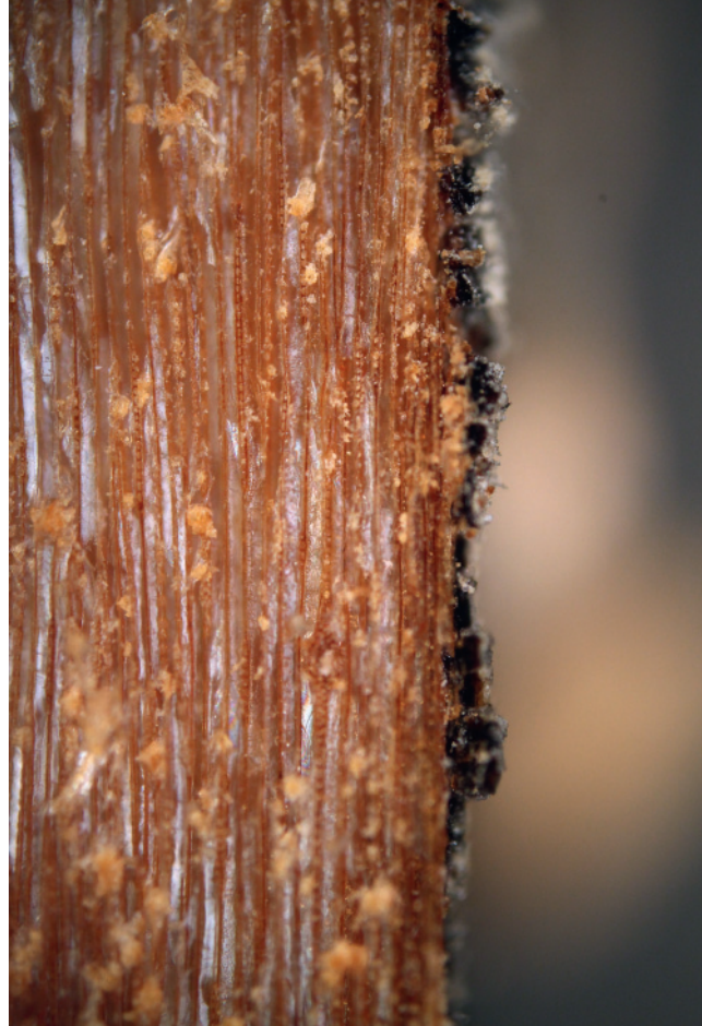
Abb.7 Holzoberfläche mit tiefschwarzer und gleichmässiger Farbschicht. Querschnitt in 200-facher Vergrösserung, Auflicht.
