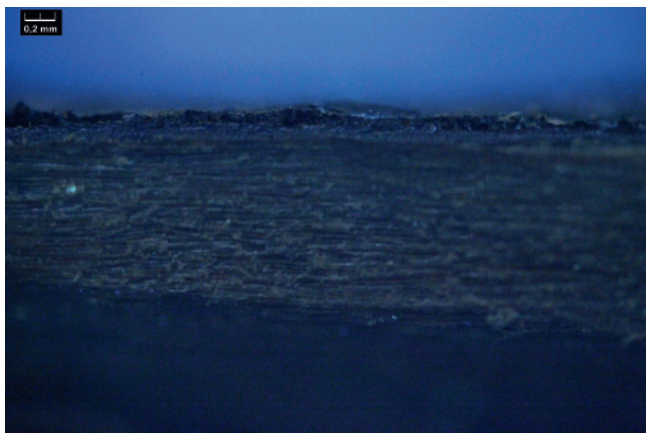
Abb.12 Gleicher Querschnitt wie in Abb.11 unter UV-Licht. Die beiden Anstriche sind gut zu unterscheiden. Querschnitt in 50-facher Vergrößerung, UV-Licht.
