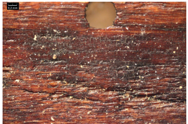
Abb.13 Der bauzeitliche Anstrich bedeckt die Frassränder des Wurmlochs. Oberfläche in 50-facher Vergrößerung, Auflicht.
