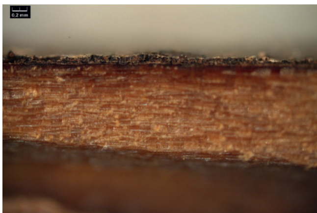
Abb.11 Im Querschnitt sind die beiden Anstriche gut zu sehen. Der untere, bauzeitliche ist sehr fein; das Bindemittel ist ins Holz eingedrungen und hat eine leicht rötliche Färbung hinterlassen. Der obere Anstrich ist dicker und sehr gleichmässig aufgetragen. Querschnitt in 50-facher Vergrößerung, Auflicht.
