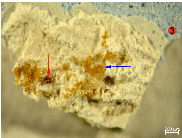
Abb. 13 Rückseite des Fassungspakets auf der Türleibung mit sehr kleinen Fragmenten einer ersten roten Fassung (roter Pfeil links), eingebettet in ein Bindemittel (blauer Pfeil mittig). Im Bruch ist auch die hellblaue Schicht zu sehen (roter Punkt 3 rechts).
