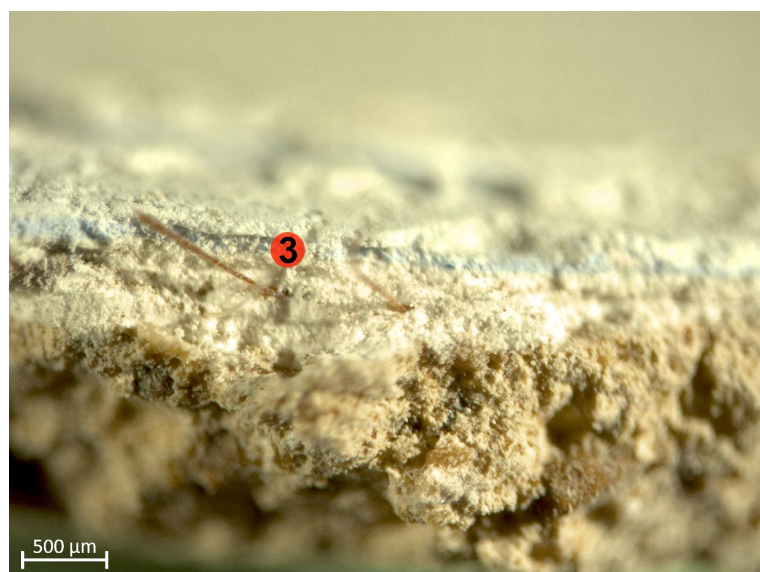
Abb. 15 Fassungspaket der Seitenwände unter der Lichtnische mit deutlich weniger Schichten (ca. 5 Schichten). Hier liegt das Hellblau (Schicht 3) auf Ausbesserungsmörtel mit Haararmierung.
