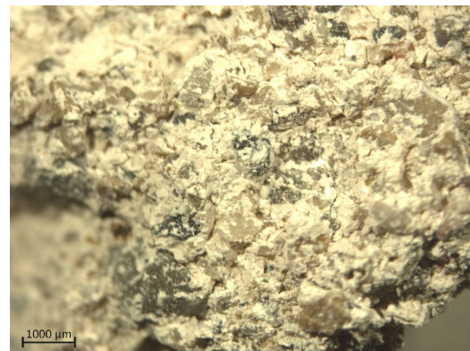
Abb. 5 Mikroskopische Ansicht des Deckputzes im Gewölbe, datiert auf die zweite Hälfte des 16. Jahrhunderts
